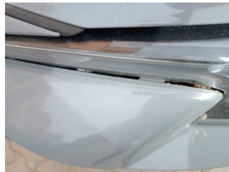
Bouclier avant (Défaut aspect)
